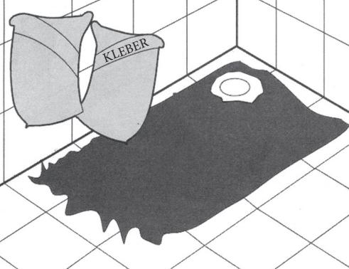
Na rovnú a čistú plochu nanesieme slabú vrstvu cementového lepidla tzv. kleber.
