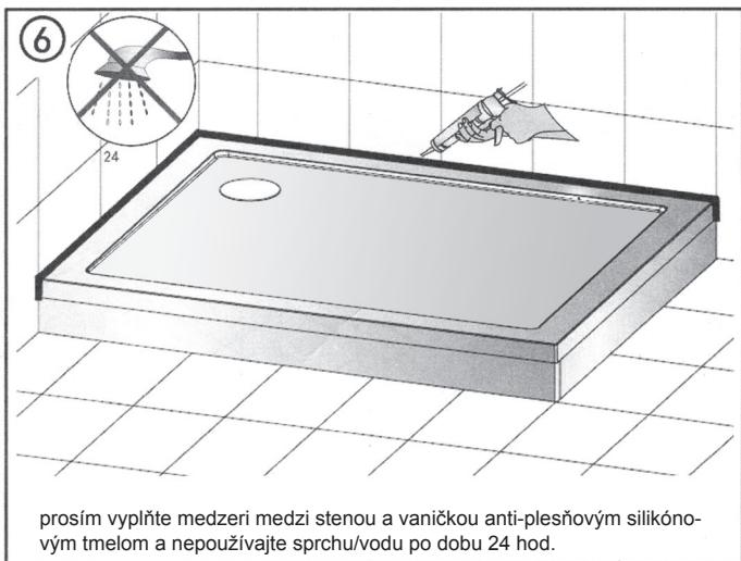
prosim vyplňte medzery medzi stenou a vaničkou anti-plesňovým silikónovým tmelom a nepoužívajte sprchu/vodu po dobu 24 hod.
