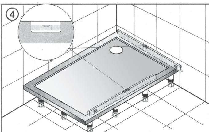
Postavte vaničku na nožičky. Otáčaním nožičiek upravte vaničku podľa vodováhy do roviny. Po nastavení roviny zafixujte nožičky o podlahu pomocou silikónového tmelu.
